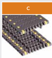
Série HP 8505 MTW PT PASSO: 3/4 pol (19,05 mm) ALTURA: 0,35 pol (8,7 mm) Para transportadores de alta velocidade em fila única. Orifícios de vácuo opcionais.
