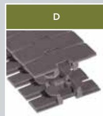
Série HP 880 TAB PASSO: 1,5 pol (38,1 mm) ESPESSURA: 0,15 pol (4,0 mm) Para transportadores de alta velocidade em fila única com flexão lateral. Orifícios de vácuo opcionais.
