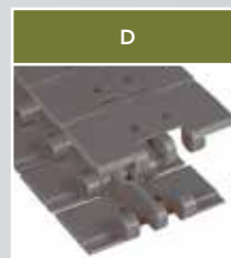
Série HP 820 PASSO: 1,5 pol (38,1 mm) ESPESSURA: 0,15 pol (4,0 mm) Para transportadores a vácuo de alta velocidade em fila única.
