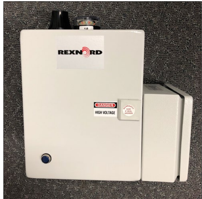
Figura 13 – Conjunto do dispositivo Edge com antena celular opcional e luz Andon
