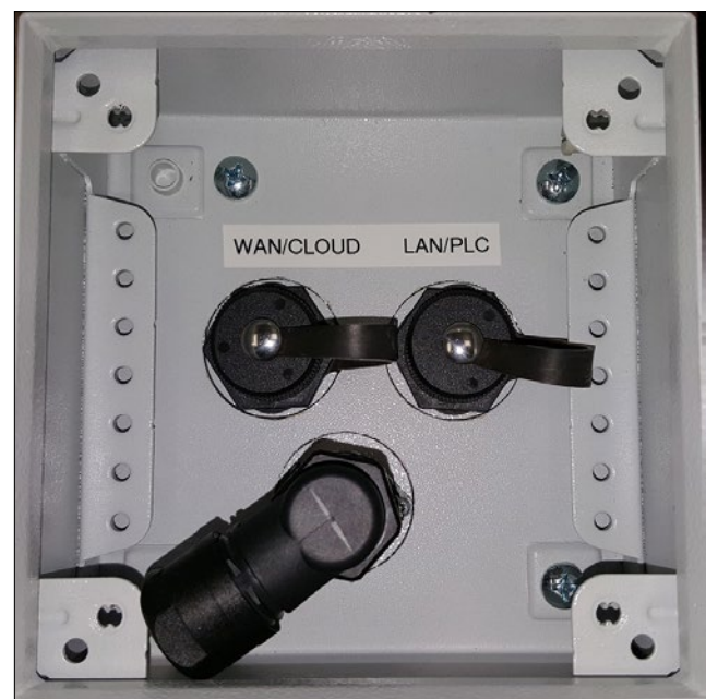
Figura 2 – Conexões de alimentação CA e de dados dentro da caixa de interface
