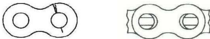
Figura 7. Placas de conexión dañadas
