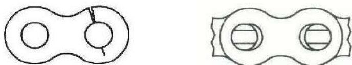
Rysunek 7 Uszkodzone płyty łączące
