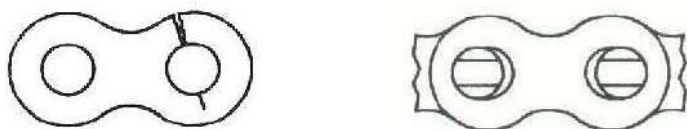
Figura 7 Piastre di giunzione danneggiate
