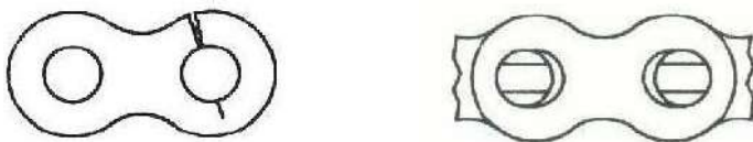
Kuva 7 Vahingoittuneet lenkkien levyt
