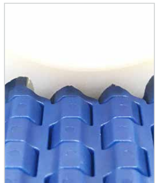
Acoplamiento optimizado entre cadena y piñón
