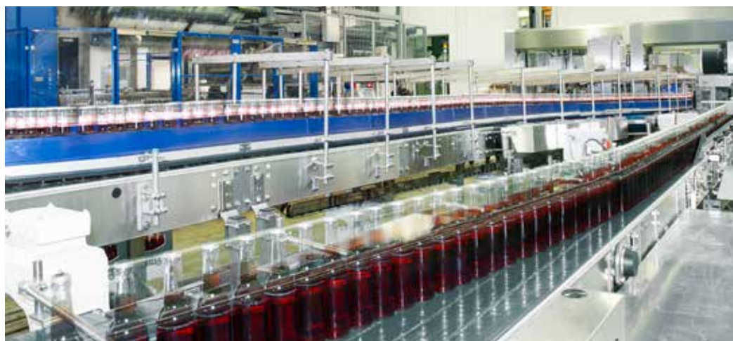
Línea de llenado de botellas de vidrio de alta velocidad, equipada con cadena TableTop Rexnord.
