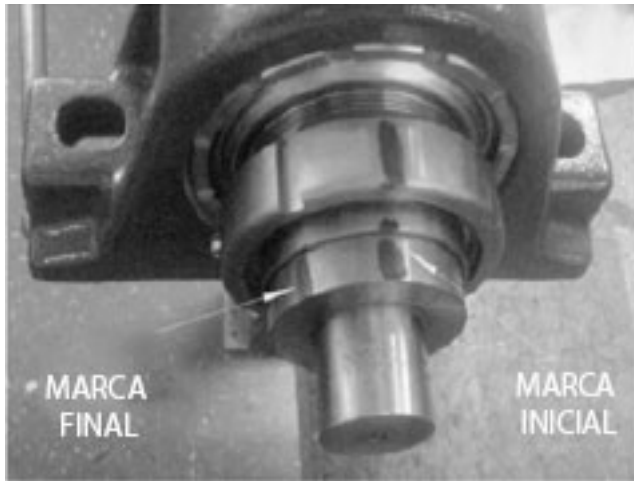
Figura 2. Posición de la tuerca de seguridad en relación con la flecha
