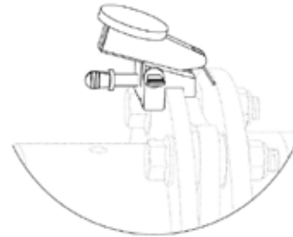
Figura 7 - Comprobación de la alineación angular mediante el método de comparador de carátula Rexnord.
