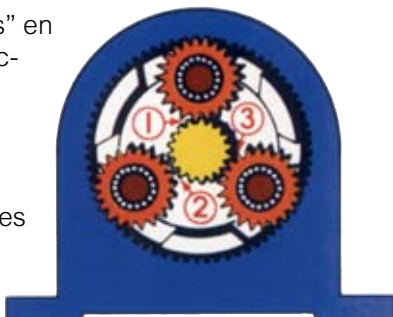
Engranajes tradicionales – solo un punto de contacto
